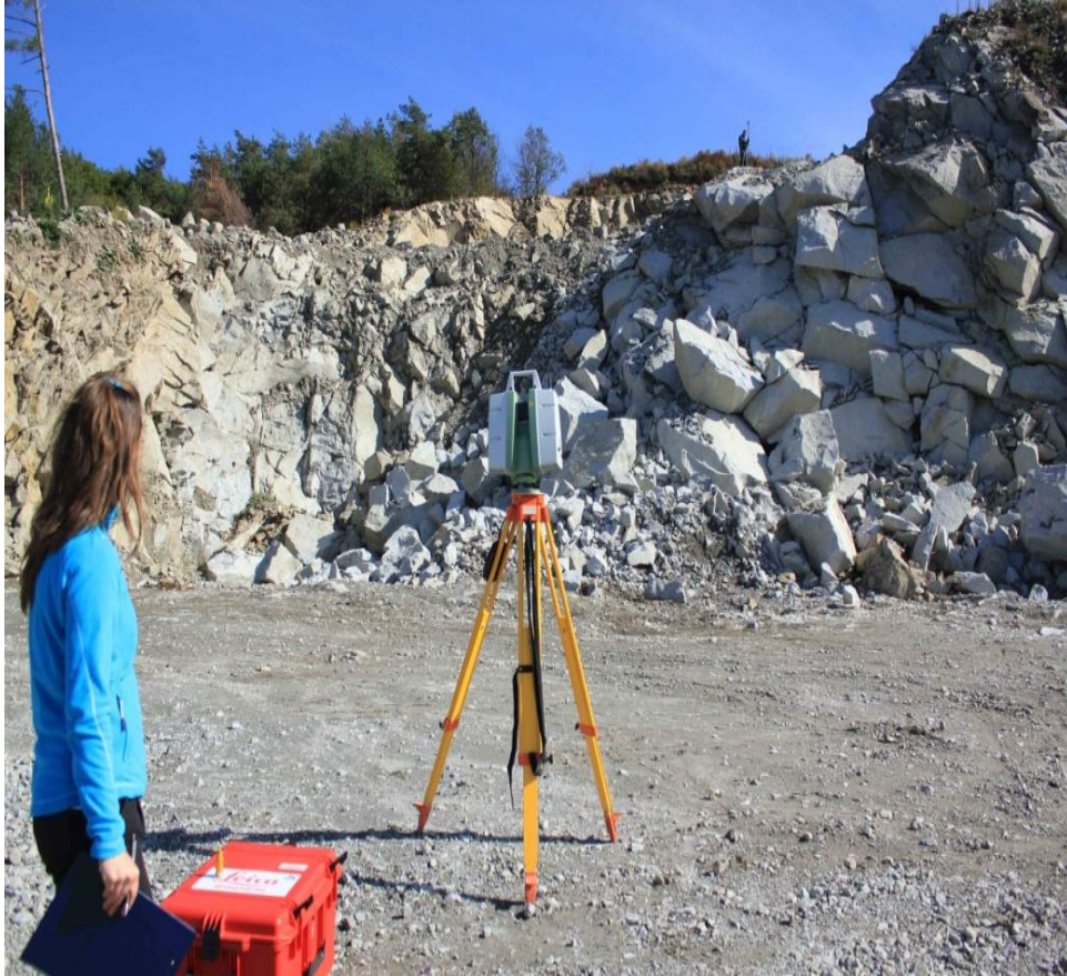
Obr. 2. Geodetické práce v lome Brestov. Zameranie steny lomu laserovým skenerom Leica ScanStation C10
